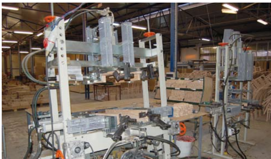
Przed montażem wszystkie czopy są dodatkowo zagniatane. FOT. IRENEUSZ MACIĄG
