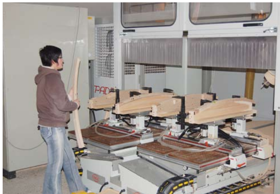
Centrum 5-osiowe pozwala na skomplikowaną obróbkę elementów. FOT. IRENEUSZ MACIĄG
