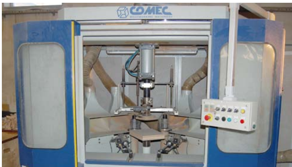
Frezarka karuzelowa obrabia element z czterech stron. FOT. IRENEUSZ MACIĄG
