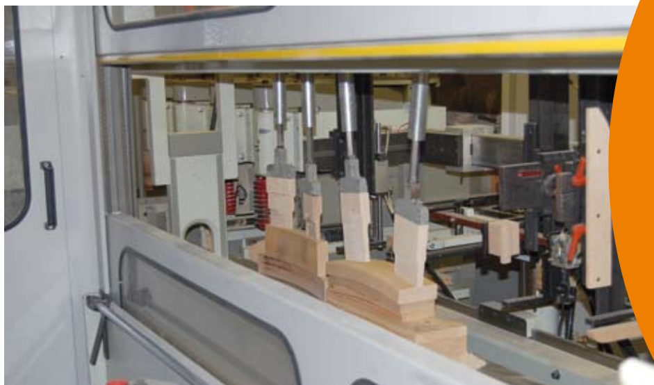
Osiem agregatów obrabia elementy na gotowo. FOT. IRENEUSZ MACIĄG
